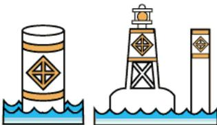
**Bouée d'endroit interdit** signale une zone interdite aux embarcations.
